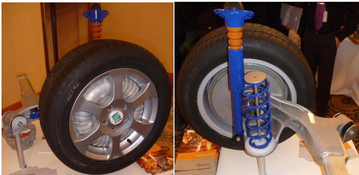
Obr. 3 Elektromotor integrovaný do litého disku kola /13/
