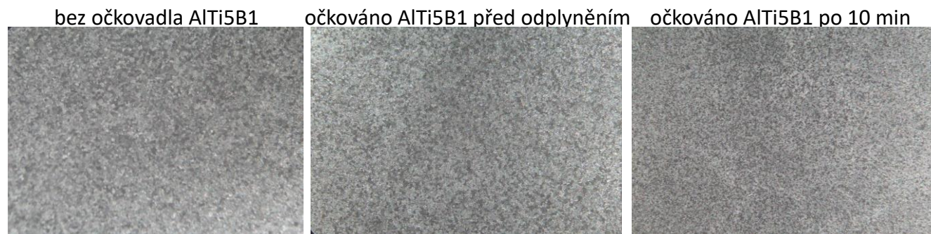
Obr. 3, Vizualizace manuálního způsobu vyhodnocování velikosti eutektických buněk dle normy ČSN 42 0462
