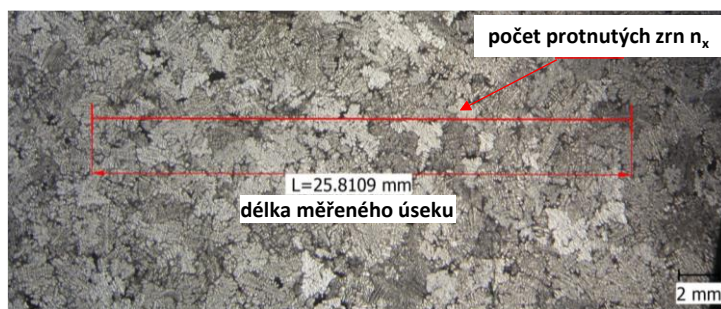
Obr. 3, Vizualizace manuálního způsobu vyhodnocování velikosti eutektických buněk dle normy ČSN 42 0462
