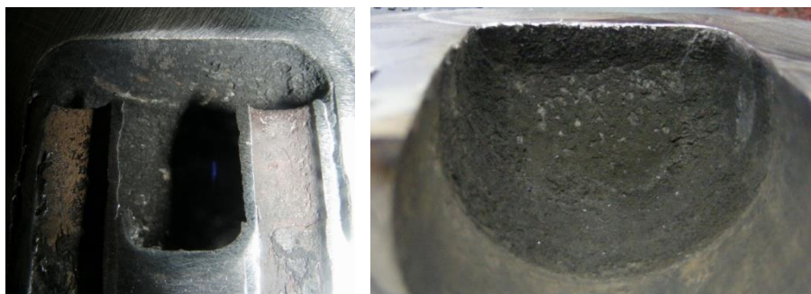
Obr. 3: Ukázka vrstvičky magnetitu (do 0,7 mm) na vnitřním povrchu ocelové chladicí vložky
