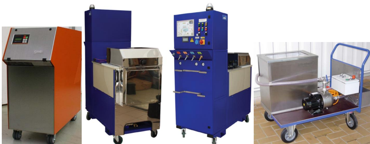
Obr. 12: Zařízení k proplachu chladicích okruhů kokil od 3 firem GWK, ELAP a Bio-Chem [1,5,6]
