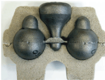
Obr. 2. Kelímky AccuVo® pro odlití 2 koulí o průměru 30 mm a hmotnosti 120 g
