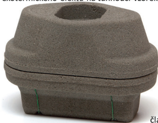
Kelímek z anorganické směsi bez exotermického efektu na tuhnoucí vzorek
