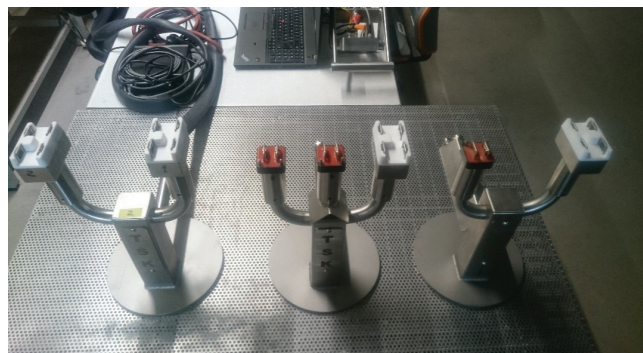
Obr. 3. Řada modifikací stativů pro měření: vlevo 2x AccuVo®, střed 2x OpenCup a jeden AccuVo®, vpravo kombinace (A-D převodník je integrován v těle stativu)
