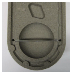
Ve středu koule je umístěn termočlánek, chráněný skleněnou trubičkou
