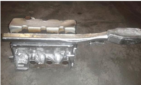
Obr. 2. Príklad odliatku plneného zhora so zložitejším tvarom zavtokovanej steny
