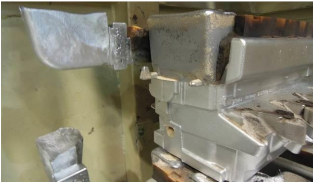
Obr. 3. Použitie penového filtra v prípade zavtokovania odliatku zhora
