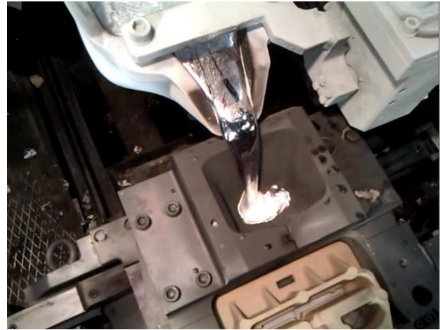
Obr. 11. Odliatok plnený spodkom s použitím filtra – poloha naberačky pri odlievaní
