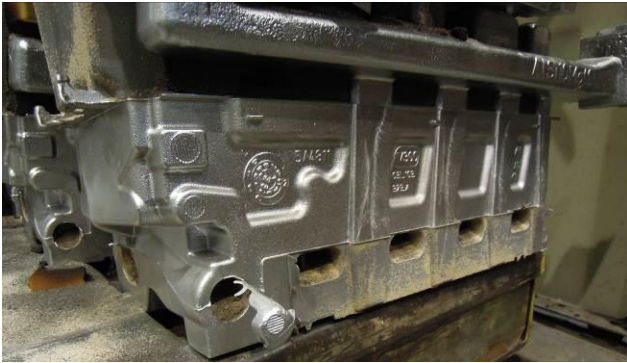
Obr. 1. Ukážka vhodnej konštrukcie vonkajšej zavtokovanej steny odliatku hlavy valcov
