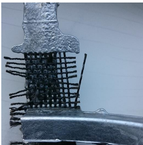
Obr. 6 Při velmi malých rozměrech stříhaných filtrů vzniká potenciální riziko nerovnoměrných ok filtru
