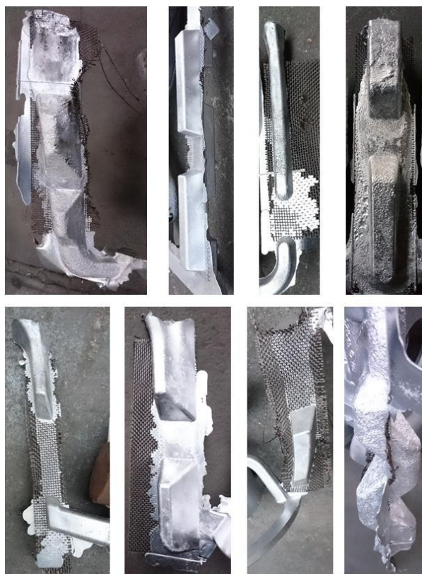
Obr. 2 Ukázky aplikace filtrů v licím kúlu v labyrintovém uspořádání (násobné až jednoduché)
