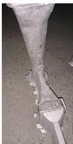
Obr. 9 Tradiční umístění komůrky pro pěnový filtr v horizontálním rozváděcím kanálu s asymetrickým napojením před a za filtrem (řídící průřez je na dně lícího kůlu před napojením na horizontální kanál)
