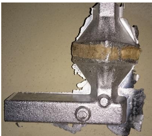
Obr. 8 Tradiční umístění komůrky nad dnem lícího kůlu, kdy konický náběh z kanálu do průřezu filtru je symetrický s opačnou stranou komůrky
