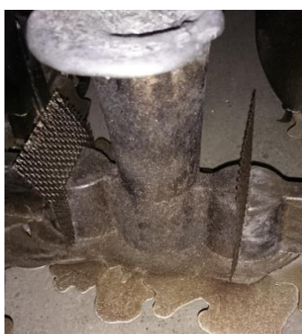
Obr. 4 Originální umístění filtru do rozváděcího kanálu – nábojka zvětšuje účinnou plochu filtru a zpomaluje licí rychlost
