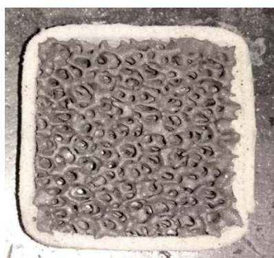
Obr. 7 Filtr s izolační vatou po obvodu, které lépe vytěsňuje komůrku, která nemusí být udržována v takové přesnosti jako v případě užití filtru bez izolace (zcela standardní způsob v případě přesného lití)
