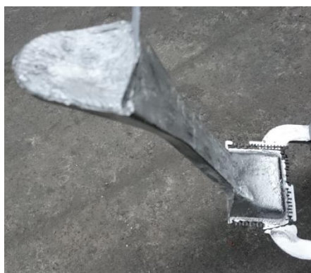
Obr. 3 Další možnost umístění filtru – na dně licího kúlu
